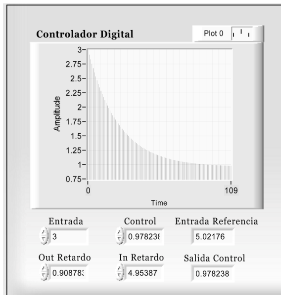
Figura 10: Panel frontal del controlador diseñado en LabVIEW.
